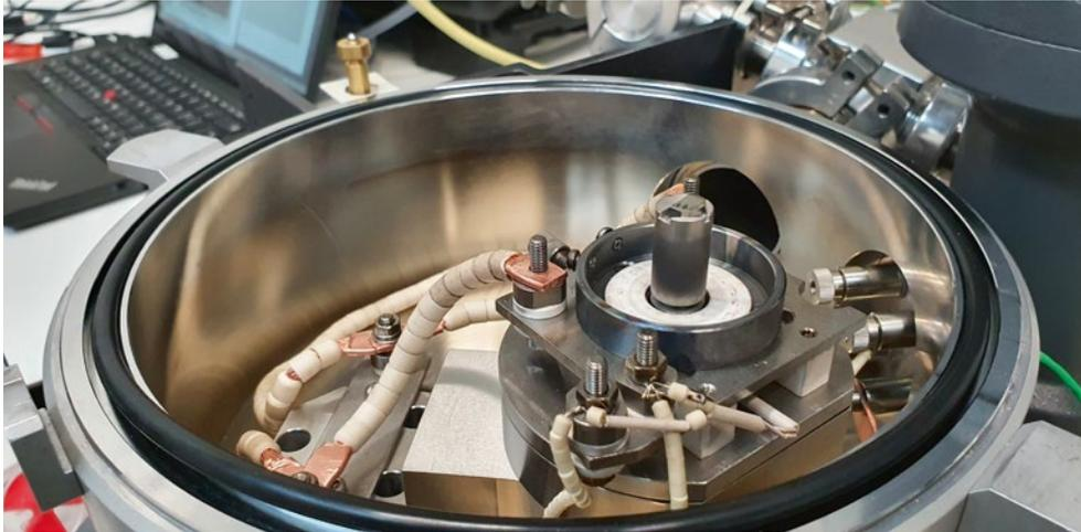
**Abbildung 25: Ansicht auf das geöffnete Messgerät für Hochtemperatur-Mikrokerbttests. Quelle: PSI**
