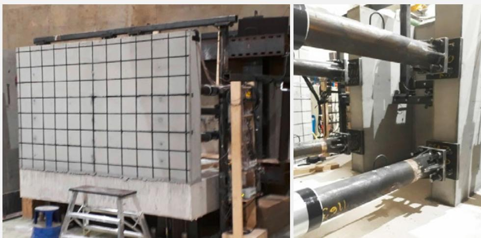
Abbildung 10: IMPACT IV – NEREID, Ansichten des Versuchskörpers für den Test NEX1 von vorne (links) und hinten (rechts). Quelle: VTT
