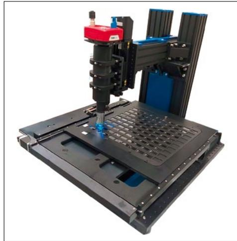
**Abbildung 22: Der Prototyp des vom PSI entwickelten Neutronendosimeter-Auslesegeräts. Quelle: PSI**
