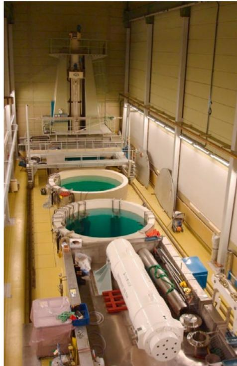
**Abbildung 7:** Aktivierte Proben von den schwedischen Kernkraftwerken werden in einem 29 Tonnen schweren weissen Behälter (unten im Bild) zur Firma Studsvik transportiert. Dort werden die Proben in rund acht Meter tiefen Wasserbecken gelagert und zu Forschungszwecken bearbeitet. Quelle: Studsvik.
