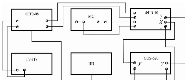
Рис. 4: Принципиальная схема экспериментальной установки
