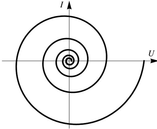
Рис. 3: Фазовая кривая осциллятора с затуханием
