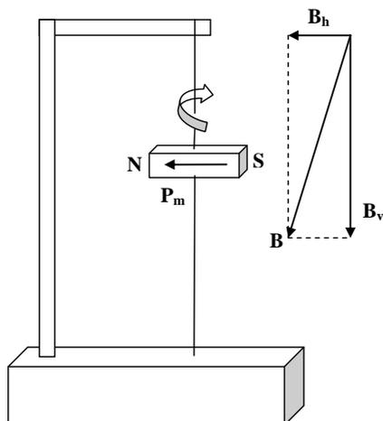
Рис. 11: Схема установки для измерения горизонтальной составляющей магнитного поля Земли
