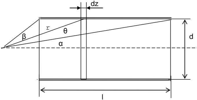
Рис. 4: К расчёту магнитного поля соленоида
