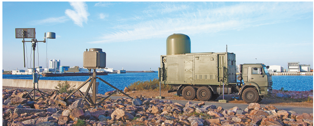
Комплекс ROSC-1 предназначен для обнаружения и распознавания различных типов воздушных объектов.
