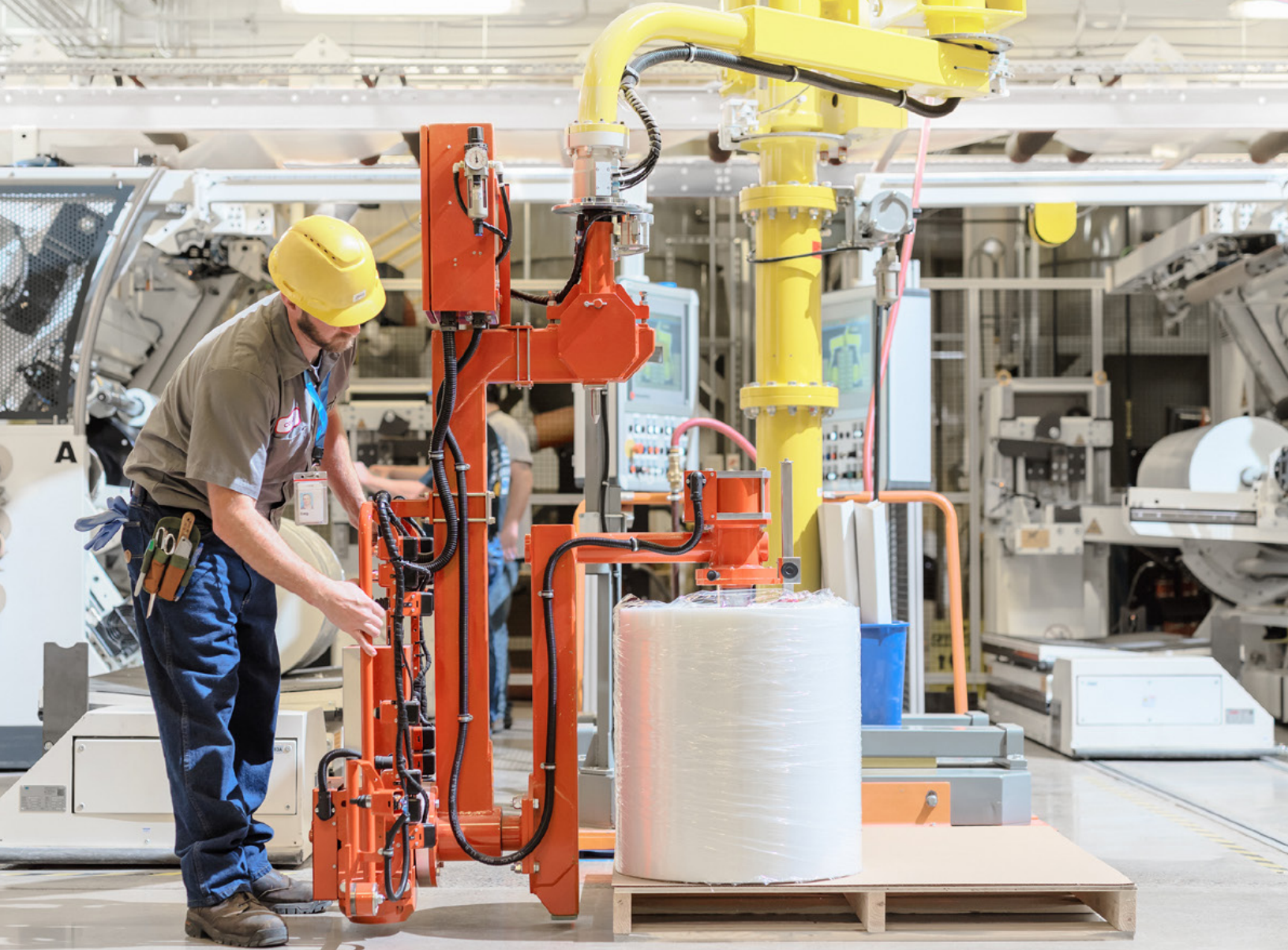
Ein Arbeiter platziert mit einem Roboterarm eine Plastikrolle sicher auf einer Palette.
