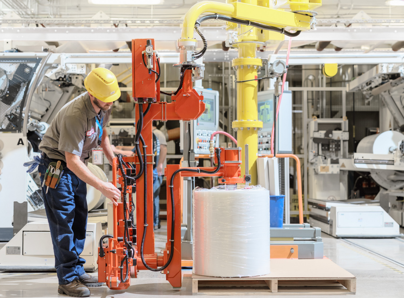
머니플레이터를 사용하여 팔릿에 비닐 롤을 안착시키는 장비 운영자.
