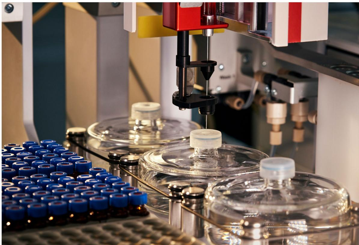
Grâce à des équipements tels que ce système de chromatographie gazeuse-spectrométrie de masse, nous évaluons la présence dans les matériaux de substances faisant l'objet d'une restriction dans notre Liste des substances réglementées, notamment les COV.
