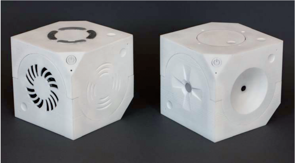
Abbildung 1: Interaktive Werkzeuge – Loaded Dice; links Aktuatorwürfel, rechts Sensorwürfel
