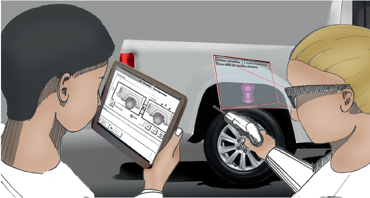
Abb. 2: Training mit einem Trainer (Tablet) und einem Teilnehmer (Datenbrille) mit zusatzlichen 3D Geometrien zur Beschreibung der Arbeitsschritte (Stufe 2).
