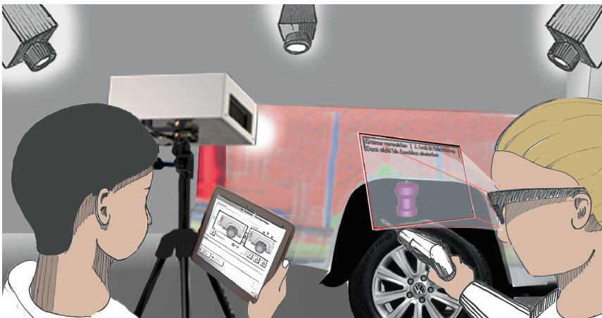
Abb. 3: Training mit einem Trainer (Tablet) und einem Teilnehmer (Datenbrille) mit AR-Inhalten und zusatzlichen 3D-Geometrien zur Beschreibung der Arbeitsschritte plus Aufprojektion (Stufe 3).
