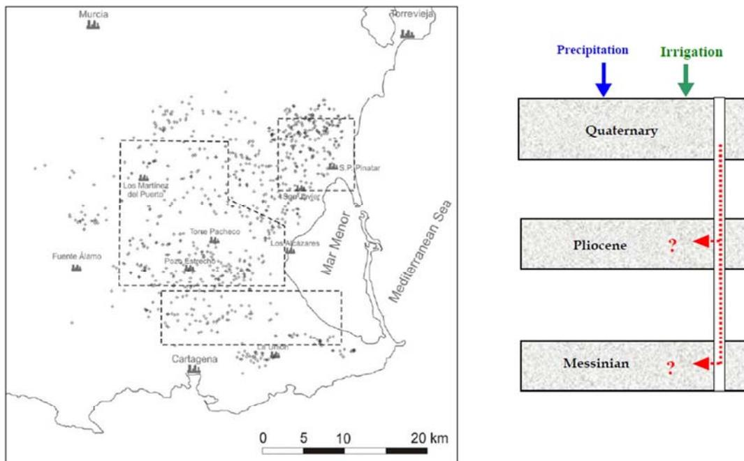
**Figura 60: Distribución espacial de los pozos de bombeo registrados en la Base de Datos del IGME existentes en el Campo de Cartagena (966 captaciones) y esquema de la conexión hidráulica entre acuíferos producida por las captaciones (IGME, 1991).**
