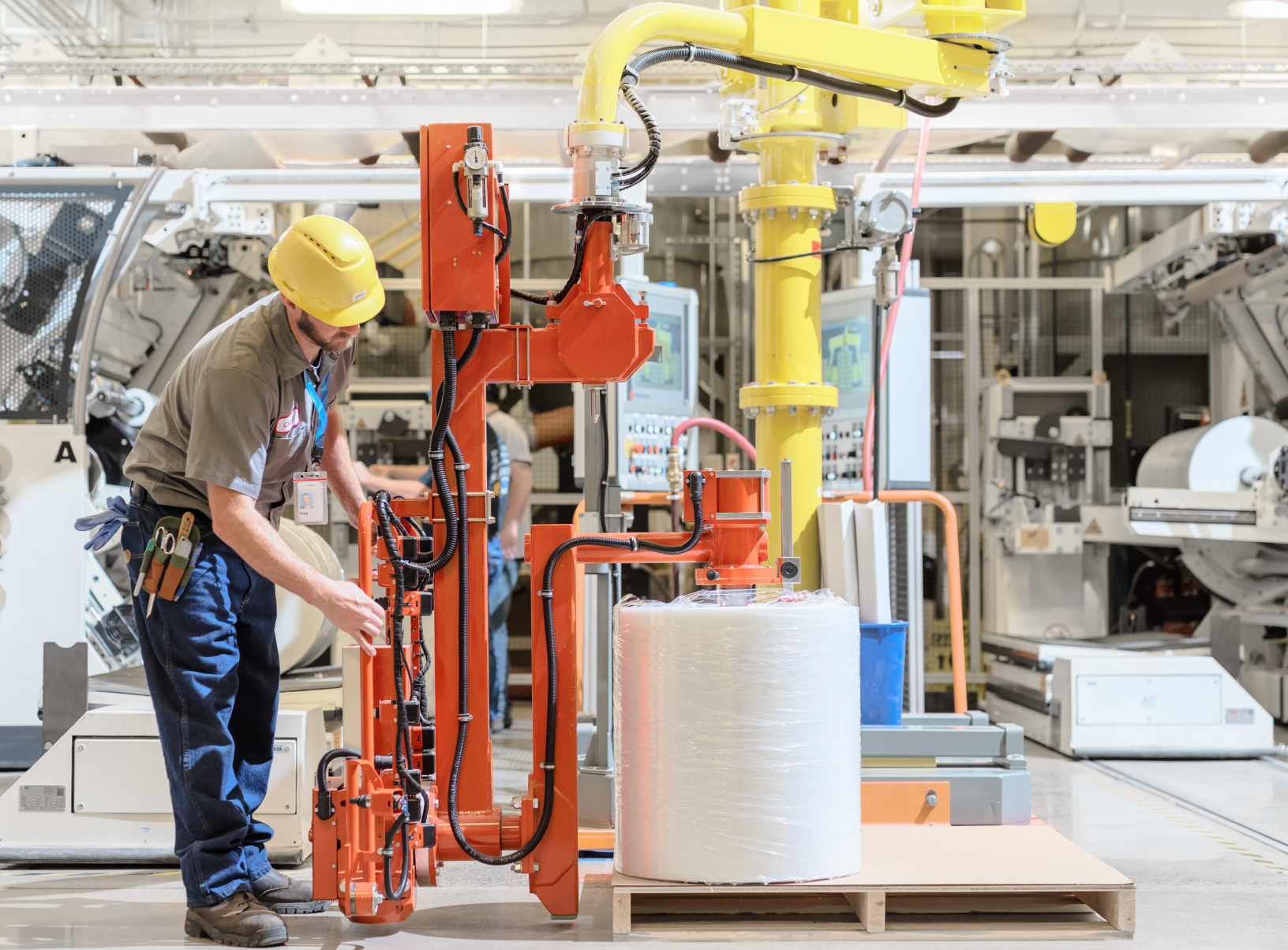
一名操作员正在使用机械臂将一卷塑料安全地放在托盘上。
