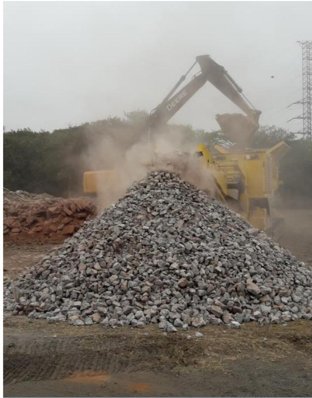
**Imagem 03:** processo de britagem de blocos de concreto
