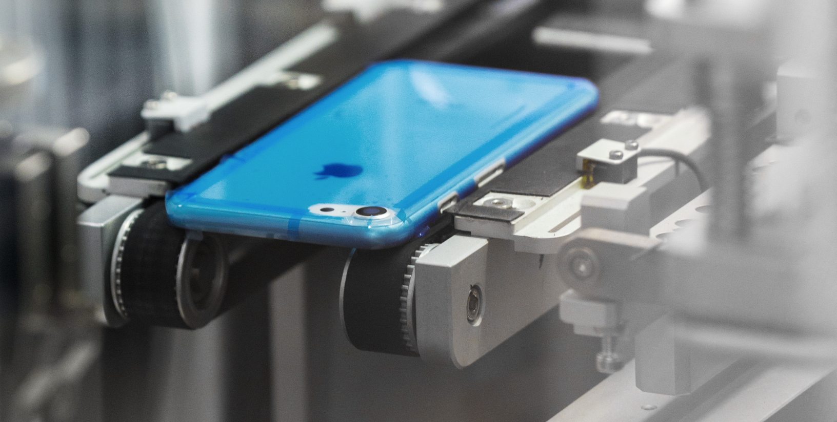
Aanbrengen beschermfolie, iPhone-productie, China
