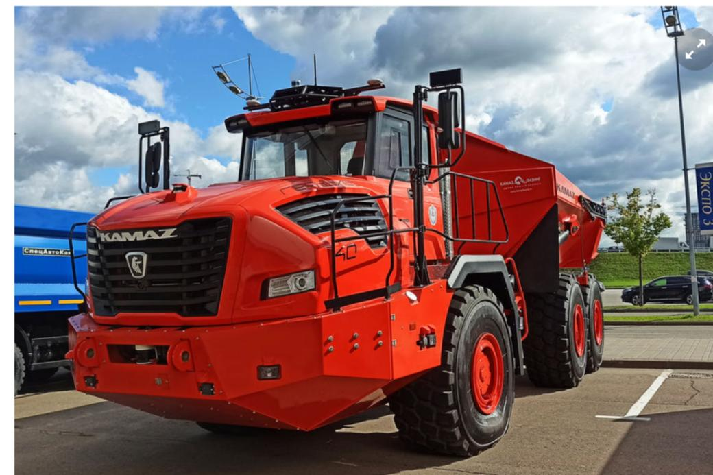
Шарнирно-сочлененный самосвал «Геркулес», разработанный «КамАЗом», способен перевозить 40 тонн и снабжен дизель-электрической силовой установкой с электромоторами мощностью 635 л.с. © Тимур Хасанов/«Газета.Ru»
