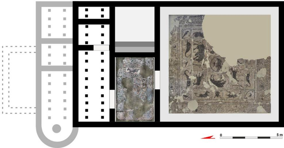
Figura 63. Propuesta de restitución de la planta del *balneum*. Según autores
