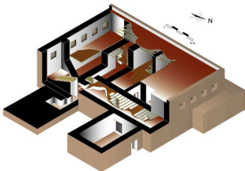
Figura 32. La Mata de Campanario. Propuesta de solución de cubierta (Duque, 2004: fig. 7.3.32).
