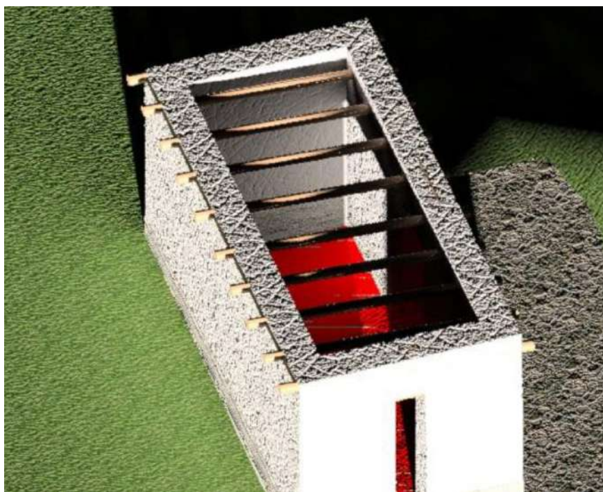
Figura 31. Propuesta de cerramiento de cubierta del edificio cultural de Aliseda (Pérez Gutiérrez et al. 2016: fig. 4).
