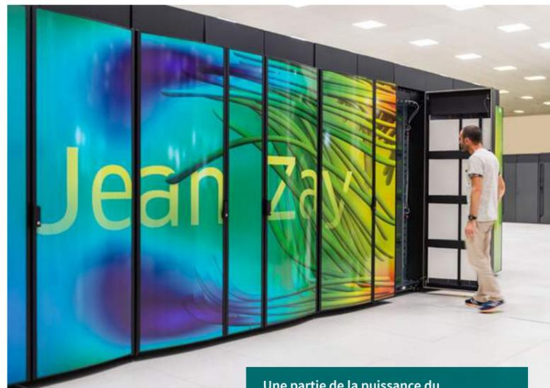
Une partie de la puissance du supercalculateur Jean Zay, capable d'effectuer 28 millions de milliards d'opérations par seconde, a été mise à disposition de la recherche contre le Covid-19.
