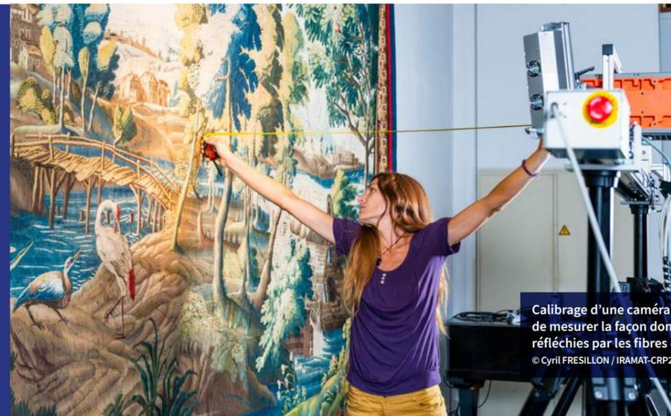
Calibrage d'une caméra hyperspectrale qui permet de mesurer la façon dont les ondes lumineuses sont réfléchies par les fibres d'une tapisserie du XVIII<sup>e</sup> siècle.
