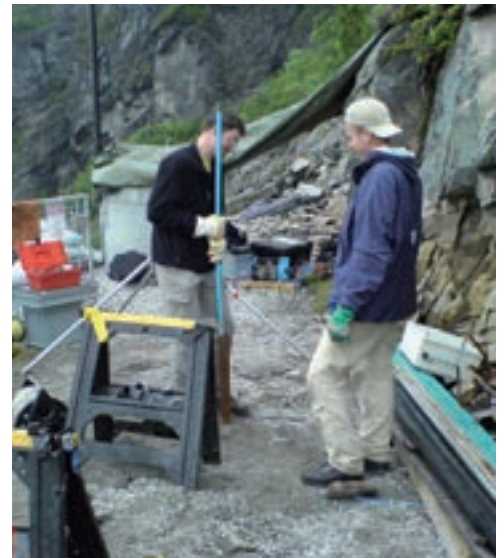
Bohrloch-Logging in Felsrutschung in Norwegen.
