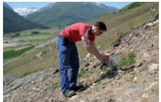
Der Bleigehalt in einer Bodenprobe wird mit einem mobilen Röntgen Fluoreszenz Gerät gemessen
