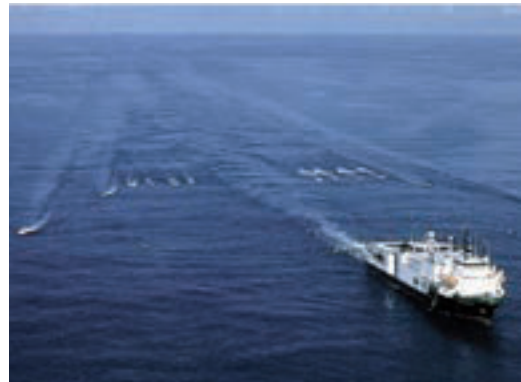
Schiff mit Sonden beim Sammeln von marinen seismischen Daten.
