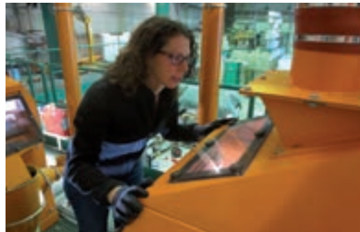
Kontrolle am Trenntisch für die Dichttrennung der metallischen Fraktion.
