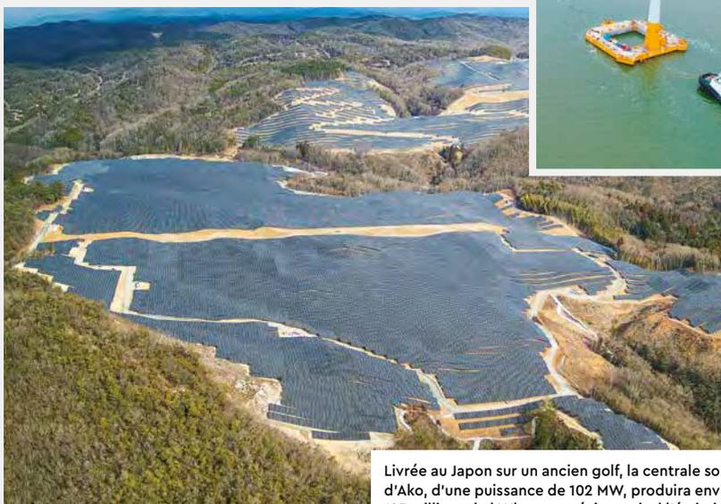
Livrée au Japon sur un ancien golf, la centrale solaire d'Ako, d'une puissance de 102 MW, produira environ 125 millions de kWh par an, évitant ainsi l'émission annuelle d'environ 5 tonnes de CO<sub>2</sub>.
