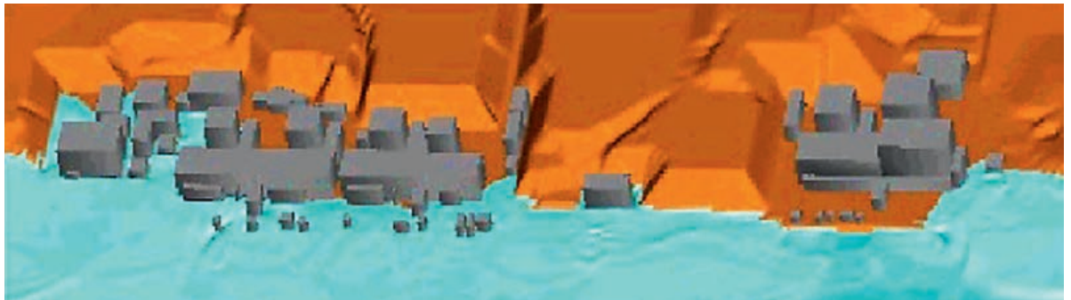
Abbildung 3: Darstellung der Überschwemmung des Standorts Fukushima Daiichi (Quelle: TEPCO [4])
