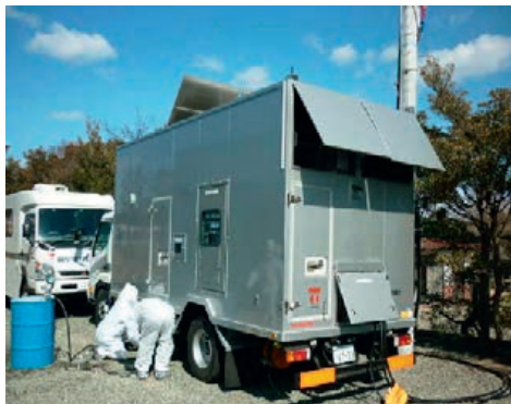
Abbildung 38: Fahrzeug mit Notstromgenerator (Quelle: TEPCO)
