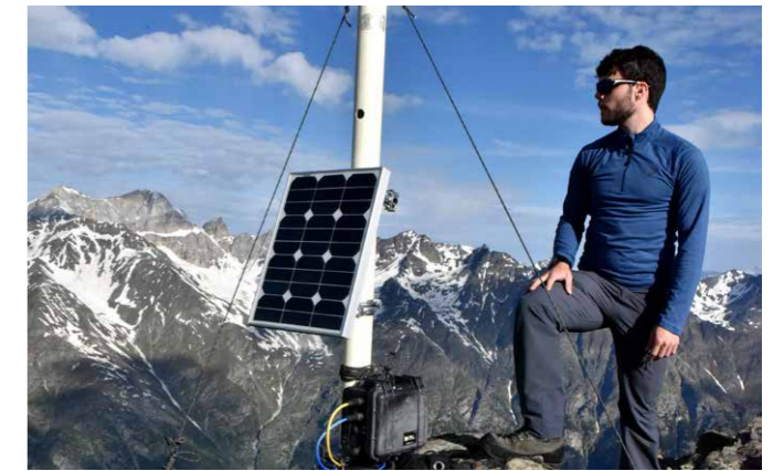
Mit einem Netzwerk aus drahtlosen Sensoren haben Forscher über mehrere Jahre hinweg die Felsbewegungen in den Schweizer Alpen untersucht. Die Resultate liefern neue Erkenntnisse, wie man Bergstürze in Permafrostgebieten frühzeitig erkennen kann.
