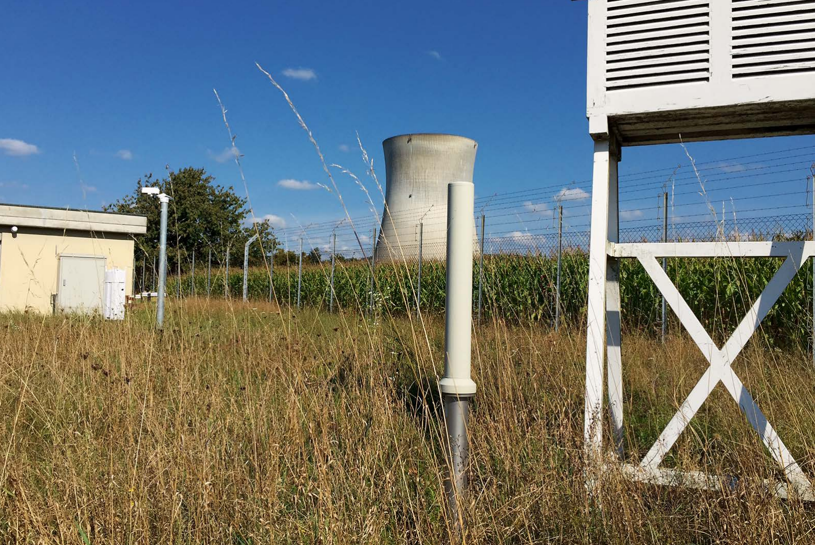
MADUK-Sonde des ENSI zur automatischen Dosisleistungsüberwachung
