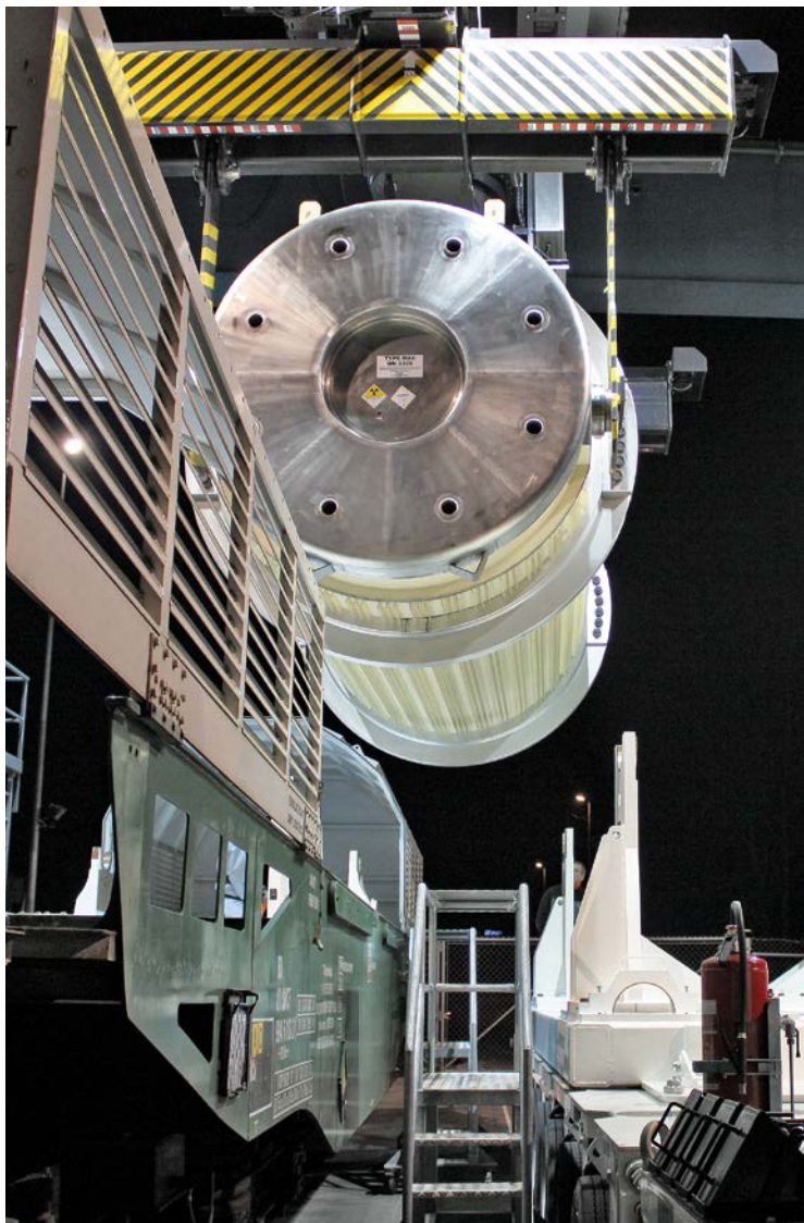
Umladen eines Transport- und Lagerbehälters. Foto: Zwiilag
