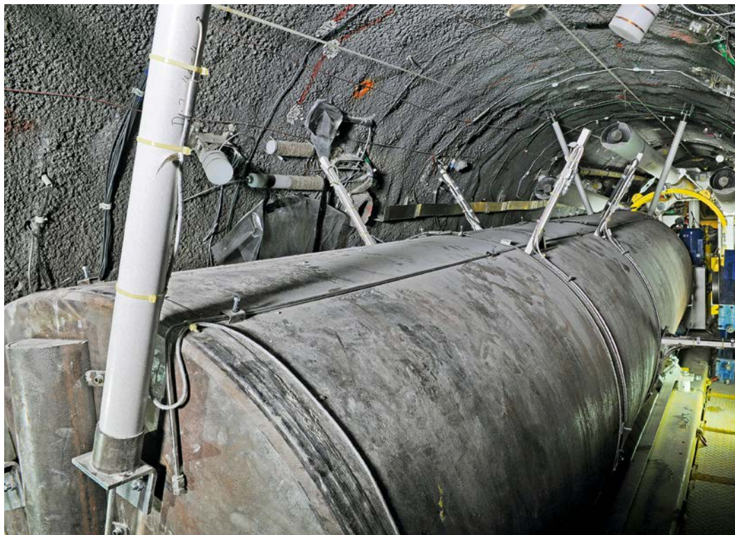
Vorne: Wärmetestbehälter, hinten: Verfüllmaschine. Foto: Comet
