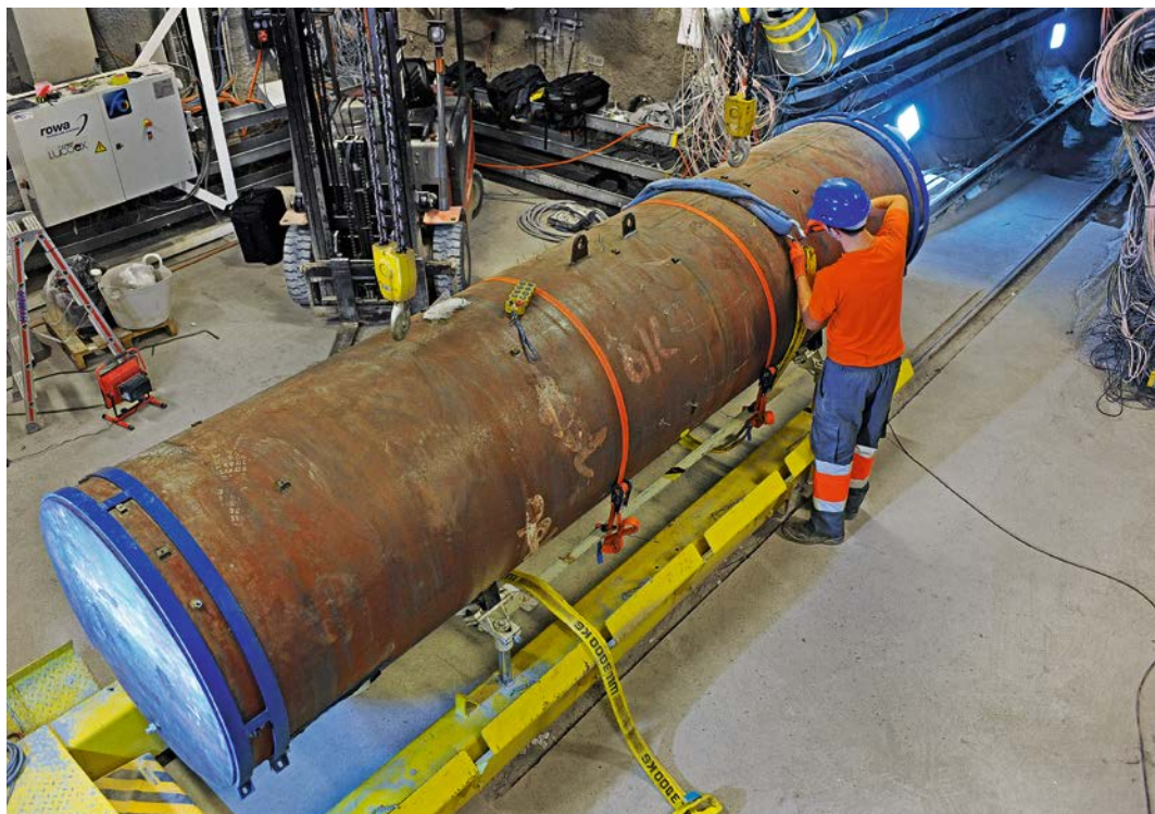
Vorbereitung des Testbehälters für den Einbau in den Versuchsstollen. Foto: Comet
