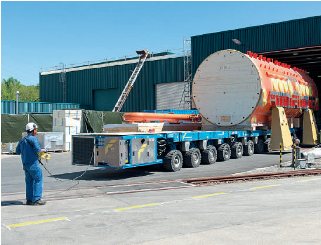
Stator auf einem Tieflader. Foto: KKG.
