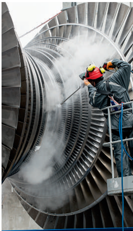
Reinigen einer Turbine. Foto: KKG.
