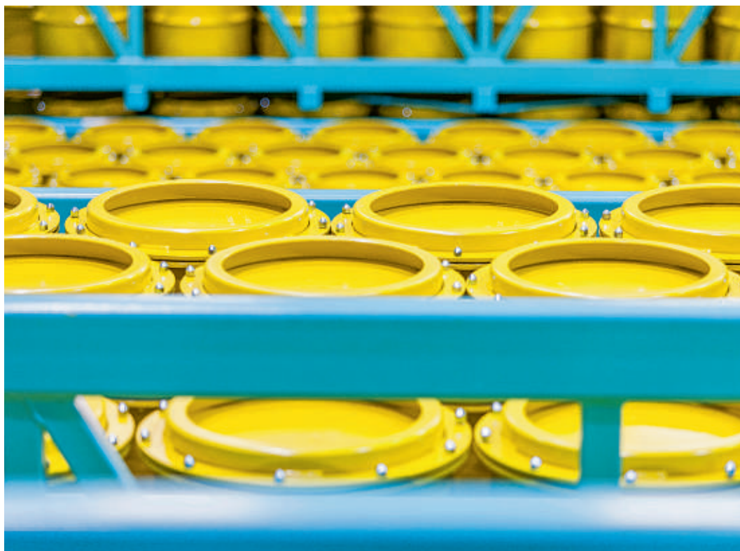
Fässer mit konditionierten Abfällen. Foto: Zwiilag.
