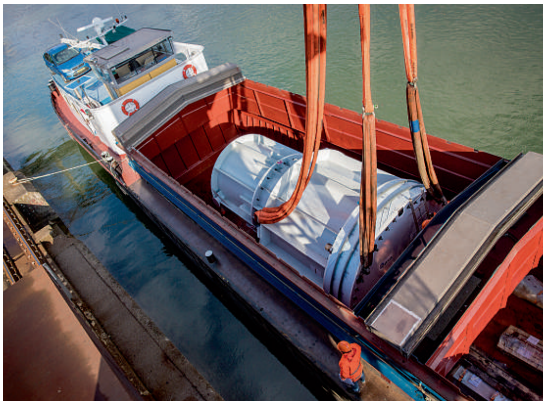
Schiffstransport des einen neuen RDB-Deckels für KKB. Foto: KKB.
