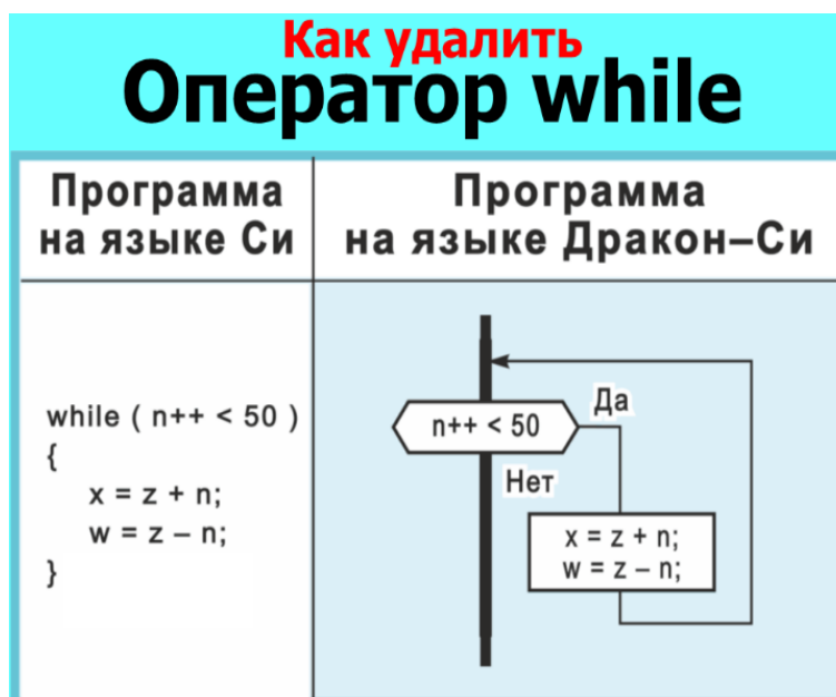
Рис. 158. Оператор while можно удалить и заменить на управляющую графику языка ДРАКОН
