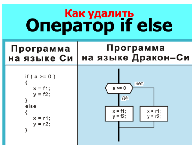
Рис. 161. Оператор if else можно заменить на управляющую графику
