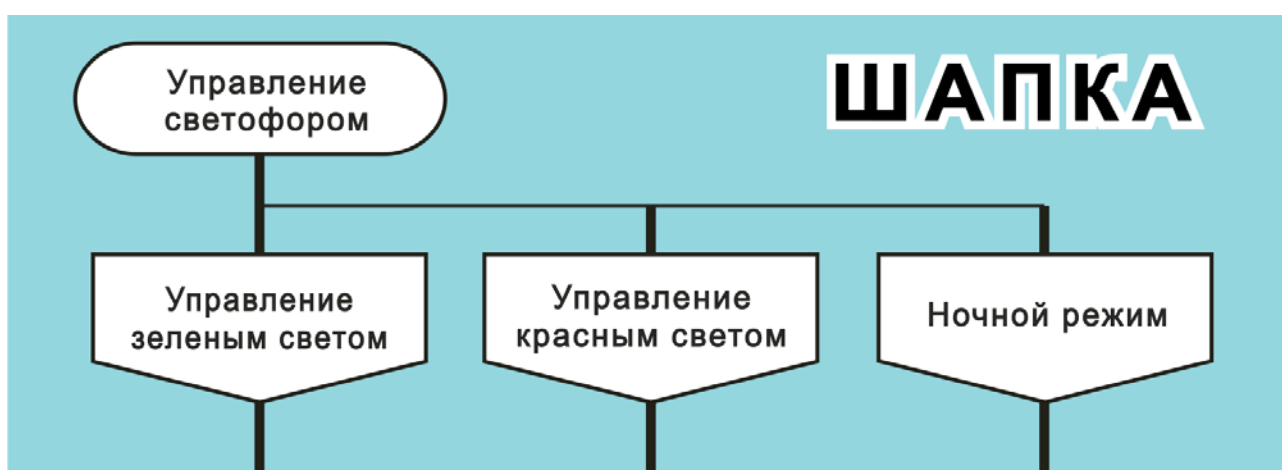
Рис. 114. Шапка алгоритма «Управление светофором». Показаны икона Заголовок и три иконы «Имя ветки»
