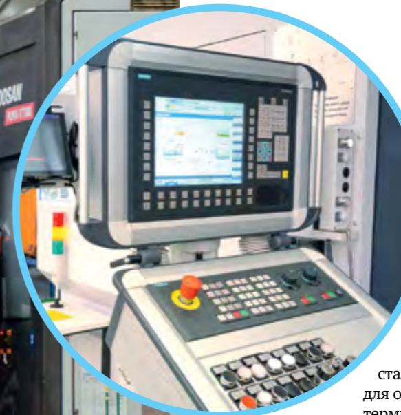
< На металлообрабатывающих станках в цехе № 1 установлена система мониторинга производственного оборудования
