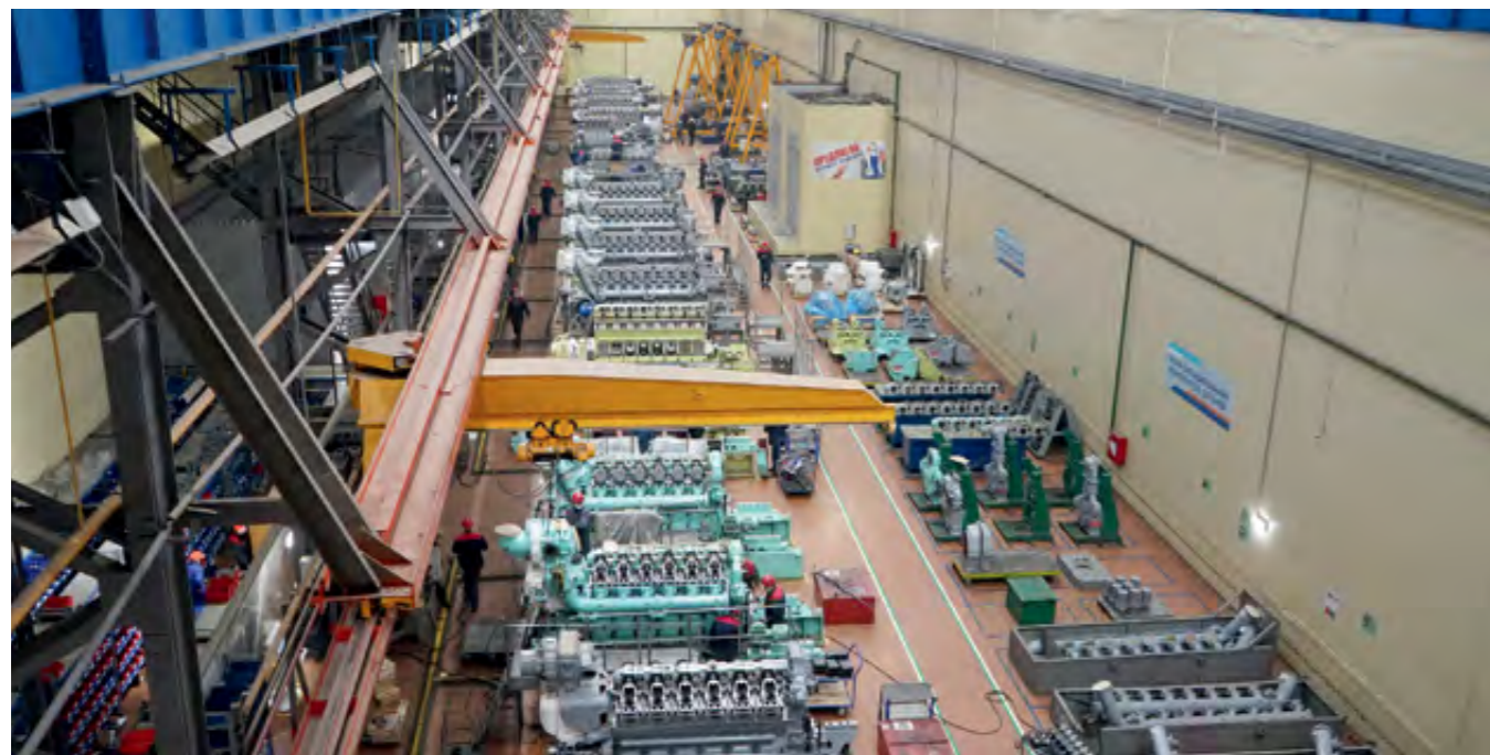
▼ Эталонная линия сборки дизельных двигателей
