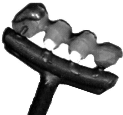
Рис. 9. Установка литниковой системы.
