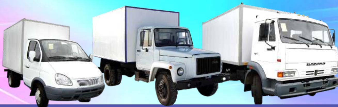
Автомобили специальные грузовые с изотермическим кузовом на базе шасси ГАЗ и КАМАЗ Нижегородская обл. ФКУ ИК-14, Респ. Башкортостан ФКУ ИК-7
