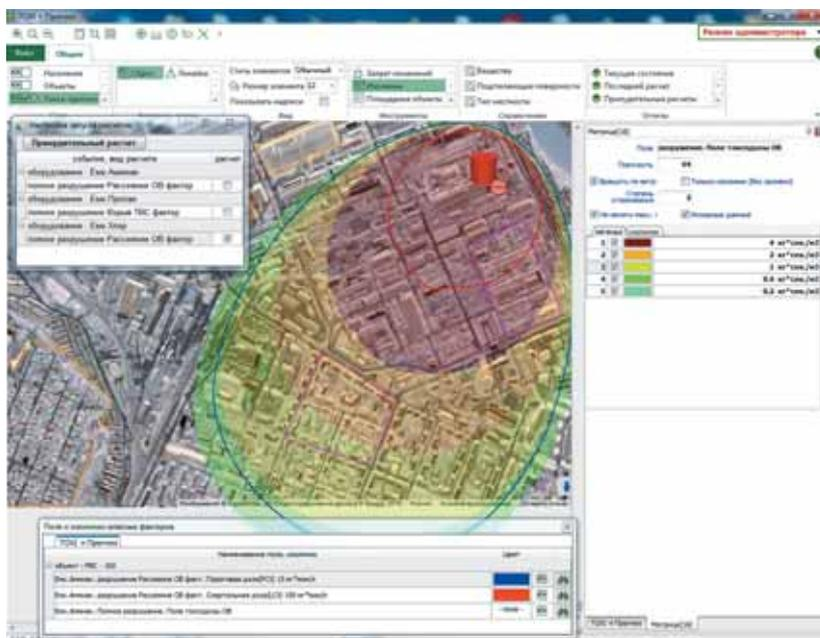
▲ Рис. 2. Рабочее окно программы и результаты расчета зон действия различных токсодоз
