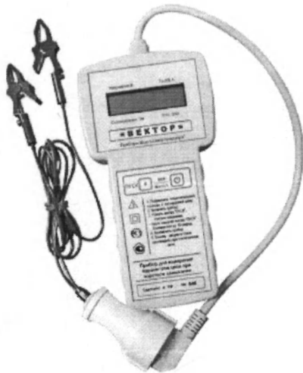
Рис.4. Прибор для измерения параметров однофазной цепи в режиме короткого замыкания "Вектор". Госреестр средств измерений № 24754-08.
