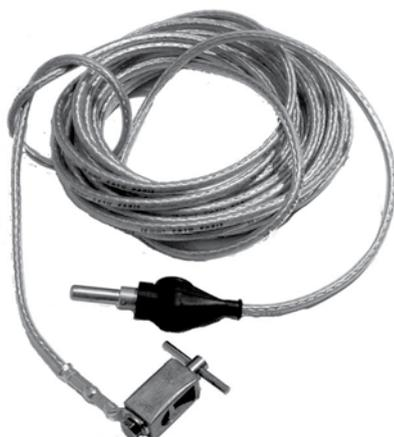
Служит для осуществления заземления на изолированных воздушных линиях. Гибкий медный провод, защищенный силиконовой оболочкой, позволяет производить работу при низких температурах. Оснащено модулем для соединения с устройством для короткого замыкания и струбциной для присоединения к стержню заземления.
