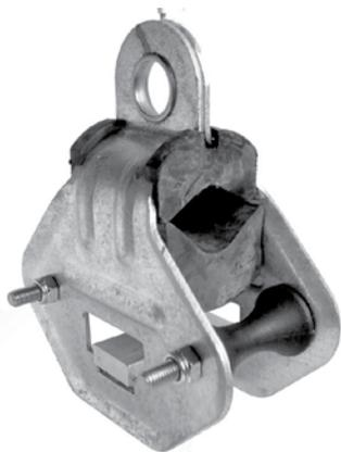
Зажим применяется для подвески провода СИП-4 сечением от 2х16 до 4х120 мм<sup>2</sup> на промежуточных и угловых опорах при углах отклонения линии до 90°.
