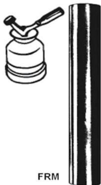
Гильзы МЖТ предназначены для соединения СИП с кабелем с круглыми или секторными жилами. Секторная жила кабеля скругляется матрицей типа MR.
