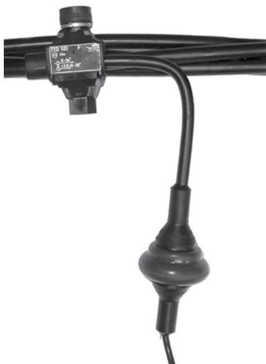
Служит для защиты оборудования от перенапряжений. Корпус, в который помещен варистор, имеет термический разъединитель, который одновременно является индикатором выхода ОПН из строя. Для подключения ОПН к сети используется прокалывающий зажим TTD151FJ или TTD241FJ (поставляется отдельно). Длина заземляющего провода - 1 м. Применение с прокалывающим зажимом ответвительного модуля FT 235 позволяет с помощью одного зажима подключить к сети и ОПН и абонента.
