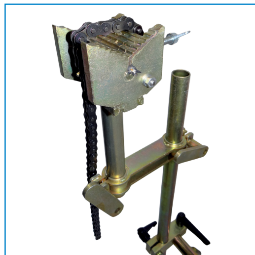
Рис.3 Зажим кабеля с цепным замком с барашком
