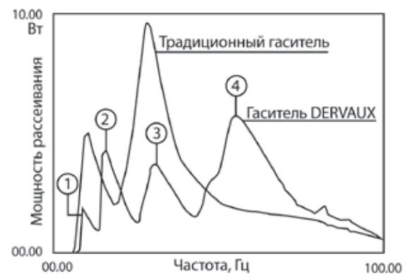
Гасители вибраций DERVAUX прошли испытания по требованиям международного стандарта IEC 61897 (Воздушные линии – Требования и испытания гасителей вибраций Стокбриджа).
