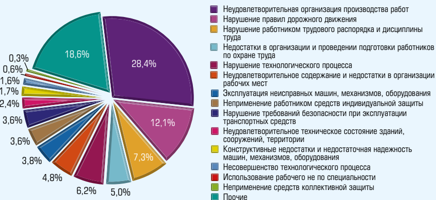
РИС. 6. Распределение количества несчастных случаев с тяжелыми последствиями по причинам происшествия в Российской Федерации в 2011 году (по данным Роструда)
