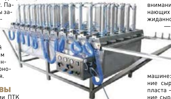
▲ Ещё один востребованный аппарат — универсальный формовочный пресс для твердых и полутвердых сыров.
