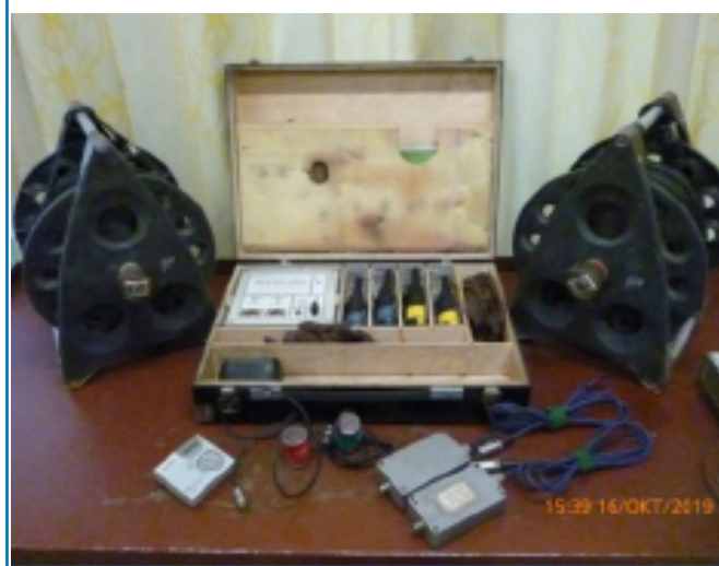
Рисунок 7. Инженерная диагностика труб с помощью течеискателя.
