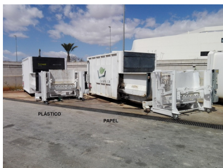
- Compactador para plásticos. - Compactador para papel y cartón. Incluyen volteador para los cubos.
