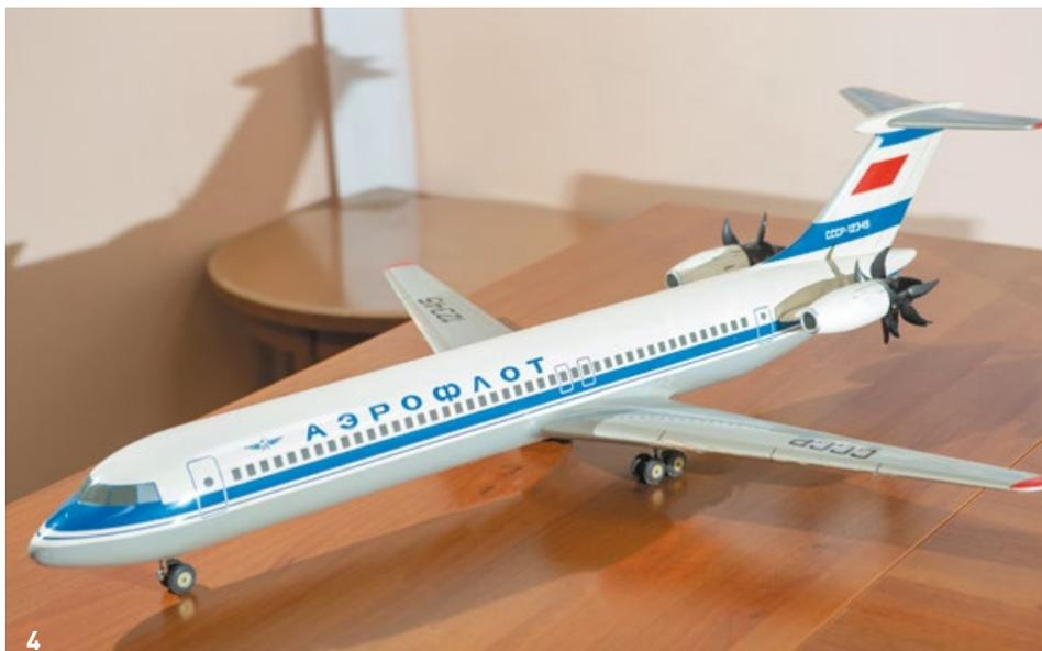
для топливной экономичности три двигателя не оптимально, лучше — два. К тому моменту в СССР существенно повысилась надежность двигателей, поэтому переход с трехдвигательной схемы на двухдвигательную не приводил к снижению безопасности. У нас в ОКБ заместителем главного конструктора по аэродинамике и прочности, впоследствии зам. генерального конструктора, работал Владимир Григорьевич Дмитриев. Он предложил повесить два двигателя на основе ПС-90 под крыло. Так в начале 1990-х
