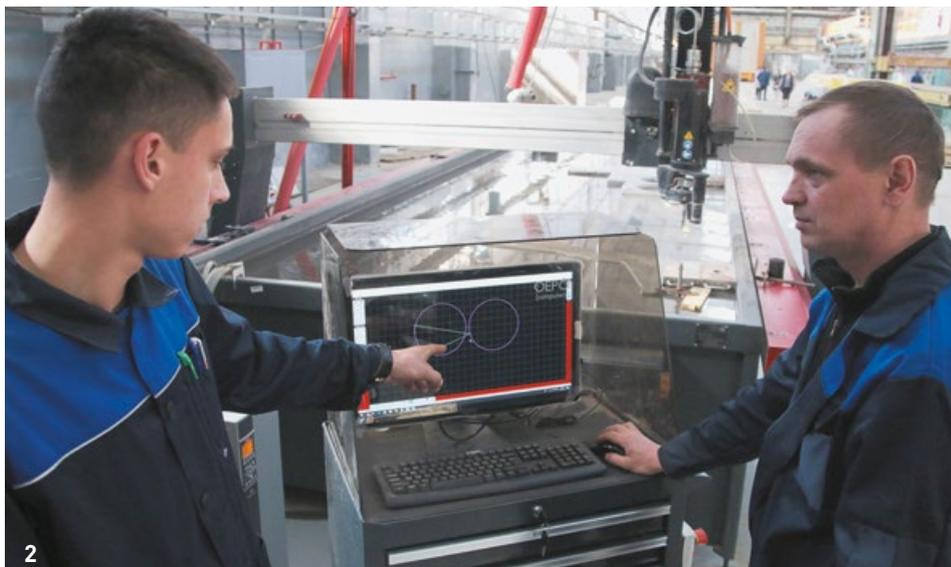
смеси воды и абразива. Их принцип работы относится к изобретениям, созданным в соавторстве с природой — так горные реки, вымывая скальные породы, прокладывают с их помощью свое русло. Два гидроабразивных пятикоординатных станка способны резать сложноконтурные детали из стали толщиной 200 мм, титана, дюрали и других материалов. Оборудование отличается эффективностью, точностью и экономией ресурсов.
