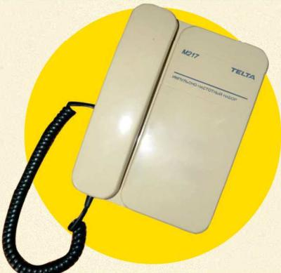
Телефонный аппарат без номеронабирателя. Предназначен для включения станции ЦБ РТС и другой аппаратуры связи.
