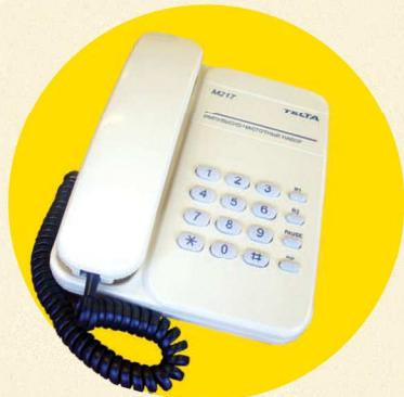
Телефонный аппарат с клавишным номеронабирателем с набором номера в десятковом и многочастотном кодах, настольное исполнение.
