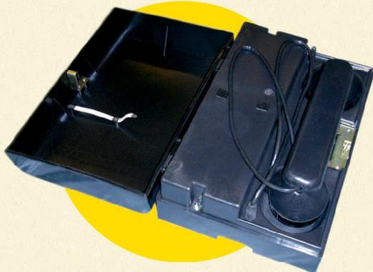
Аппарат телефонный постовой ТАП-2405 в настенном исполнении без номеронабирателя предназначен для совместной работы с коммутаторами ручного обслуживания СОС-ЗОМ, ПОС-90 и другими аналогичными коммутаторами с напряжением питания от 54 до 72 В при температуре окружающей среды от минус 40° до +45°C и относительной влажности воздуха до 98% при температуре 25°C.
