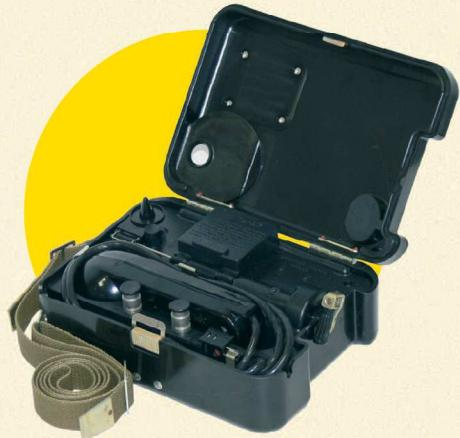
ТА-57 с индукторным вызовом предназначен для работы во временных помещениях, укрытиях и на открытом воздухе в режимах местной и центральной батарей по двухпроводным линиям связи.
