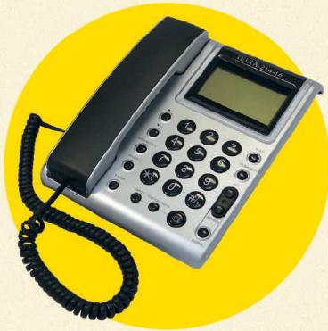
Телефонный аппарат с клавишным номеронабирателем с набором номера в десятковом и многочастотном коде, настольно-настенное исполнение. ЖКИ дисплей с пиктограммами. Память на 10 именных номеров.
