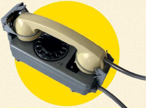
Малогабаритный телефонный аппарат с дисковым номеронабирателем, который обе спечивается видимость цифр в темноте на расстоянии 0,5 м после облучения источником света; Предусмотрено крепление к вертикальной поверхности. Предназначены для связи между абонентами корабельной и учрежденческой АТС при сопротивлении абонентских линий до 1500 Ом и напряжении питания от 24 до 60 В. Рабочая температура – от минус 40° до плюс 50° С. Аппараты устойчивы против одиночных ударов с большим ускорением.
