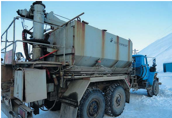
Рис. 3 Смесительно-зарядная машина МСЗ-ВУ на базе а/м УРАЛ-4320
