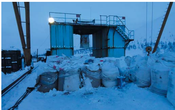
Рис. 1 Бункер для погрузки аммиачной селитры в смесительно-зарядную машину
