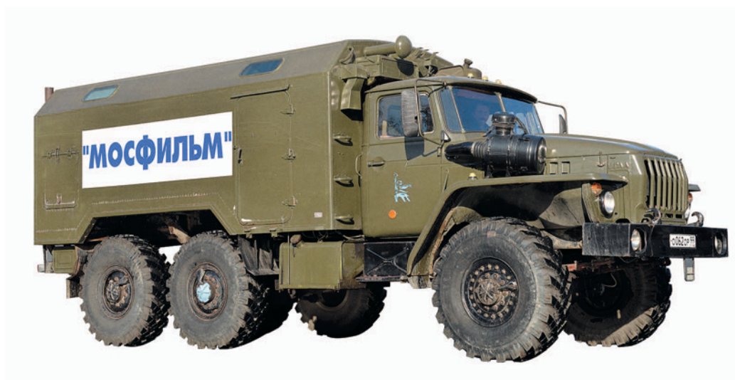
Передвижная электростанция (пихтваген) на базе автомобиля «Урал» 43203
