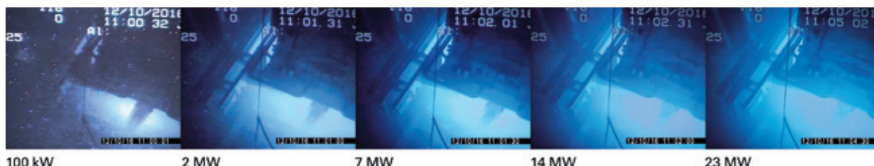
Photos de la piscine du réacteur montrant les caractéristiques de l'effet Cherenkov selon la puissance du cœur. IRSN, France
