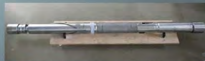
Upper Borehole Seismometer
