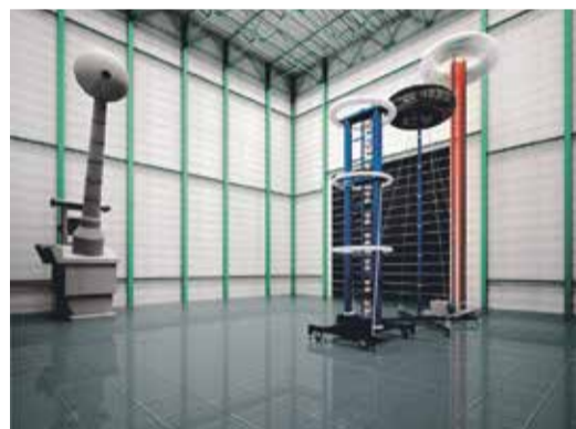
Проект лабораторного комплекса высоких напряжений с классом номинального напряжения испытываемого оборудования до 1200 кВ
