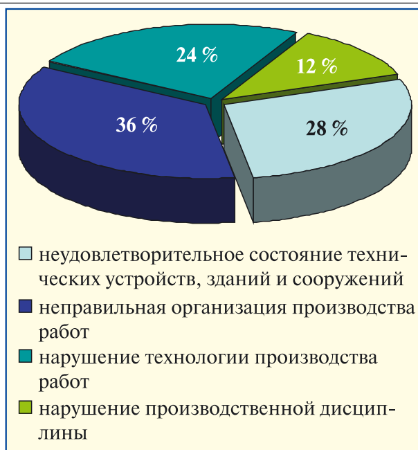
Рис. 13. Причины несчастных случаев со смертельным исходом на взрывоопасных объектах хранения и переработки растительного сырья за 2002–2006 годы
