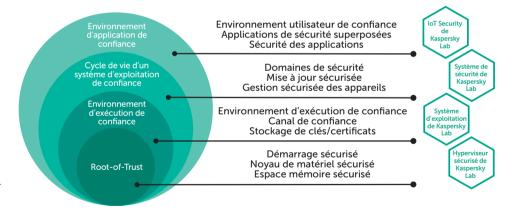
Le principe d'une chaîne de confiance constitue la base pour garantir le fonctionnement sûr d'un appareil connecté. Sans oublier les appareils et les éléments d'infrastructure (passerelles). Ce principe commence par l'utilisation d'une solution Root-of-Trust au niveau matériel.
