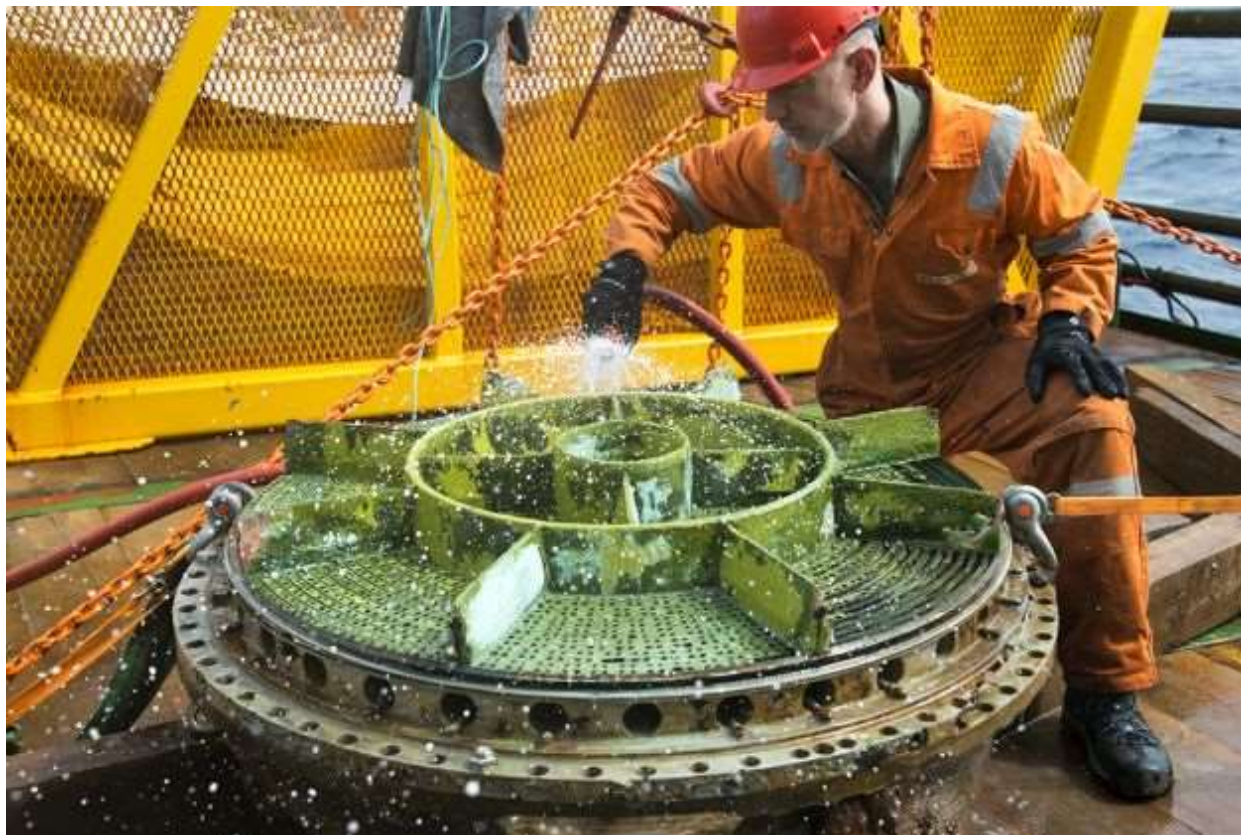
Рис.5. 29 Форсуночная головка F-1 со дна моря.
