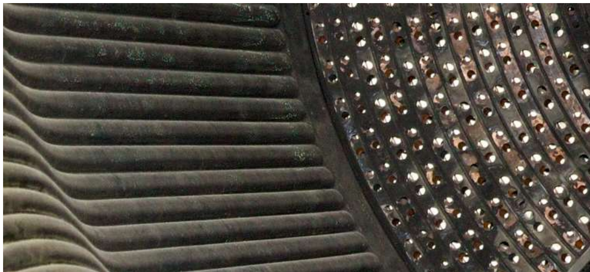
Рис.4 28 . Фото F-1 после испытания. Форсуночная головка – плоская. Струйные форсунки расположены парами кислород – керосин. Завесных форсунок керосина нет. Трубки покрыты зелеными пятнами окиси меди, испарившейся с поверхности форсуночной головки. На нижнем фото приведен увеличенный фрагмент (нижняя левая часть).
