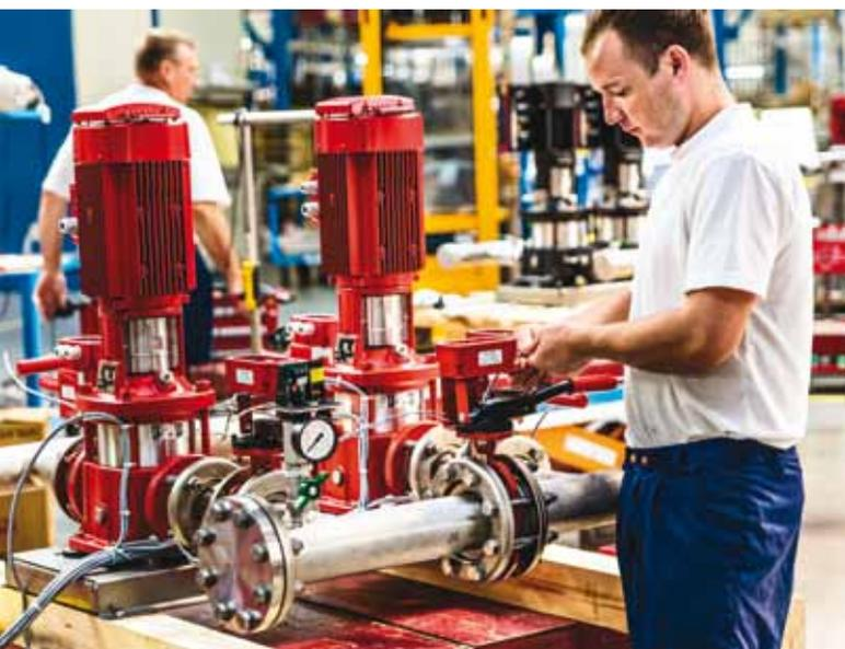
Комплектные насосные установки для систем пожаротушения Grundfos серии Hydro MX 1/1
