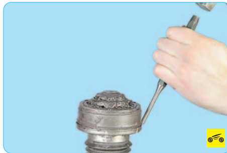
18. Сбейте с корпуса шарнира обойму защитного чехла...
