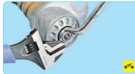
11. Удерживая шток от проворачивания, отверните гайку 5 штока амортизатора...
