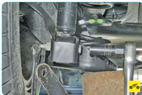
6. Отверните гайку болта нижнего крепления амортизатора к кронштейну рычага...
