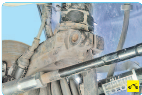
Рис. 7.2. Детали амортизаторной стойки передней подвески: 1 – амортизатор; 2 – пружина; 3 – гайка верхнего крепления амортизаторной стойки; 4 – упор; 5 – гайка штока амортизаторной стойки; 6 – верхняя опора амортизаторной стойки; 7 – опорный подшипник; 8 – верхняя опорная чашка; 9 – защитный чехол; 10 – буфер сжатия
