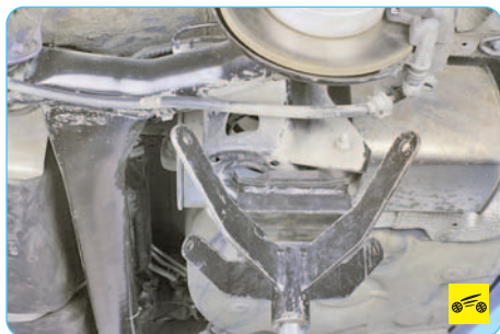
8. Выверните болты верхнего крепления амортизатора...
