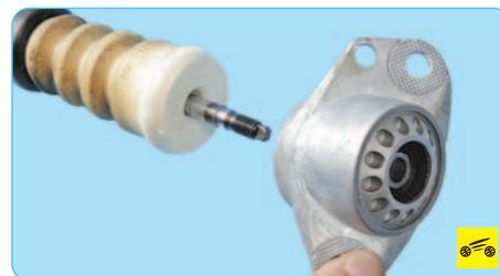
12. ...и снимите верхнюю опору 4 амортизатора 1.
