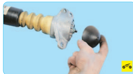
10. Снимите крышку 6 (рис. 7.4) гайки штока амортизатора 1.
