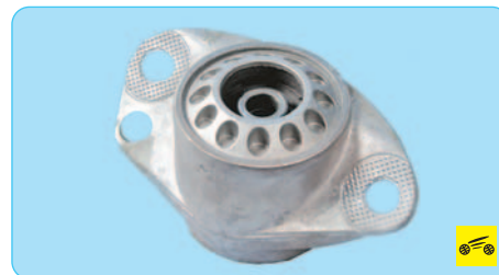
12. ...и снимите верхнюю опору 4 амортизатора 1.
