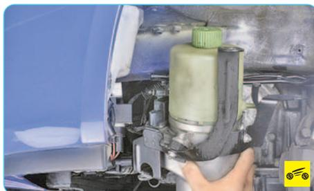
7. Выверните винты крепления и снимите электрогидравлический блок усилителя рулевого управления.
