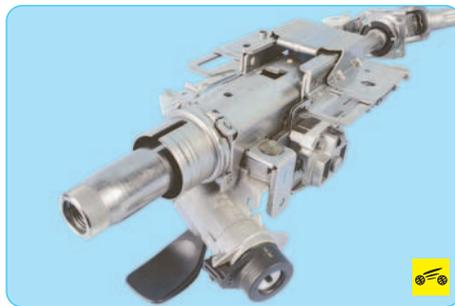
– деформация или повреждение вала и деталей рулевой колонки, повреждение шлицев соединения вала со ступицей рулевого колеса;
