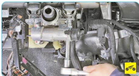
14. Выверните два болта крепления левой колонки...
