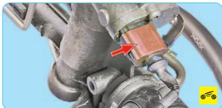
**Датчик усилителя рулевого привода** расположен в рулевом механизме. Он передает сигнал, соответствующий скорости поворота рулевого колеса, на электронный блок управления усилителем руля.
