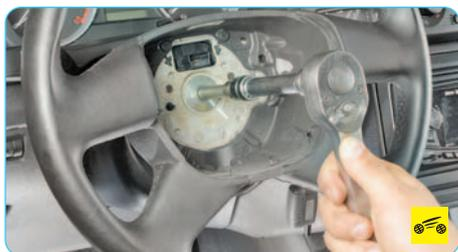
4. Ослабьте затяжку винта крепления рулевого колеса к рулевому валу, удерживая рулевое колесо от проворачивания.
