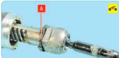
**Между корпусом шарнира рулевой тяги и картером рулевого механизма установлена фиксирующая шайба А. Не забудьте установить ее при замене рулевой тяги.**
