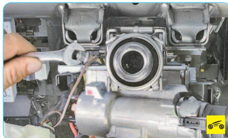
7. Выверните винт крепления провода «массы»...
