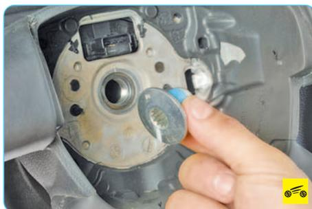
6. Окончательно выверните винт крепления рулевого колеса.
