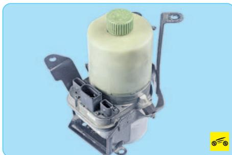
8. Установите электрогидравлический блок в порядке, обратном снятию.
