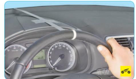
3. Не меняя положения линейки, поверните рулевое колесо влево до момента начала поворота передних колес. В этом положении нанесите на обод рулевого колеса метку.
