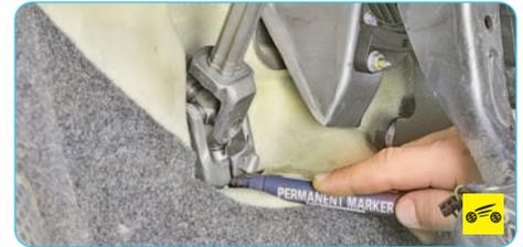
1. Пометьте взаимное положение клеммового соединения карданного шарнира промежуточного вала с валом-шестерней рулевого механизма...
