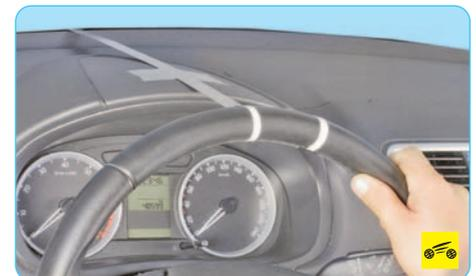
4. Не меняя положения линейки, поверните рулевое колесо вправо до момента начала поворота передних колес и в таком положении нанесите на обод рулевого колеса вторую метку.
