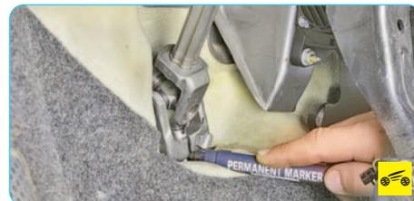
12. Пометьте взаимное положение клеммового соединения карданного шарнира промежуточного вала с валом-шестерней рулевого механизма...
