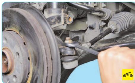
4. Отверните гайку крепления шарового пальца наконечника к рычагу поворотного кулака.
