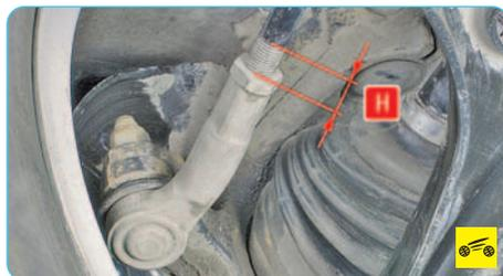
2. Измерьте и запишите длину **H** свободной части резьбы рулевой тяги, чтобы при сборке установить наконечник в то же положение и по возможности не нарушить угол схождения колес.
