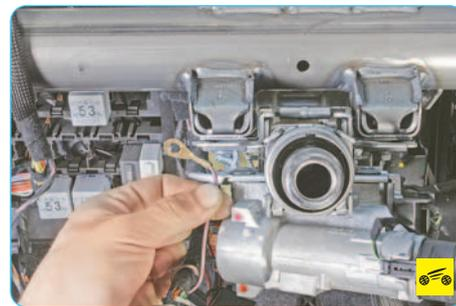
8. ...и отсоедините провод от рулевой колонки.
