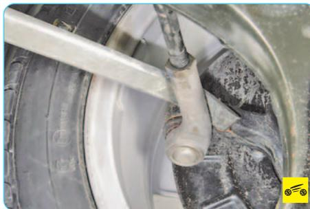
5. Проверьте наличие люфтов в шаровых шарнирах наконечников рулевых тяг. Наконечники, шарниры которых имеют ощутимый люфт, замените. Проверьте также надежность затяжки гаек пальцев шаровых шарниров наконечников рулевых тяг.
