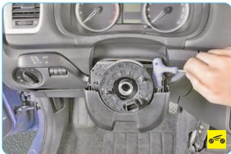
7. ...и два верхних винта крепления нижней части кожуха.
