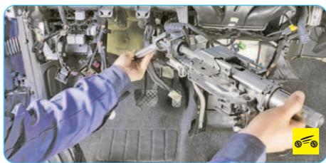
15. ...и снимите рулевую колонку с выключателем зажигания и промежуточным валом.
