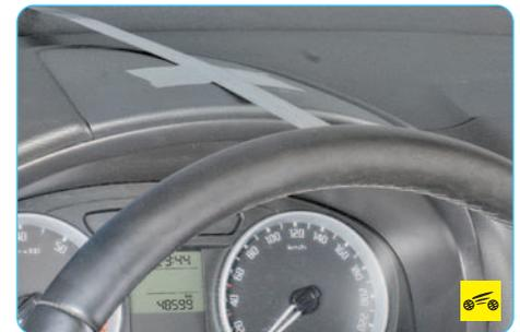
2. Установите линейку так, чтобы она была неподвижно зафиксирована на панели приборов, а плоскость линейки касалась поверхности обода рулевого колеса.
