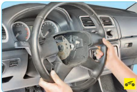
8. ...и снимите рулевое колесо.
