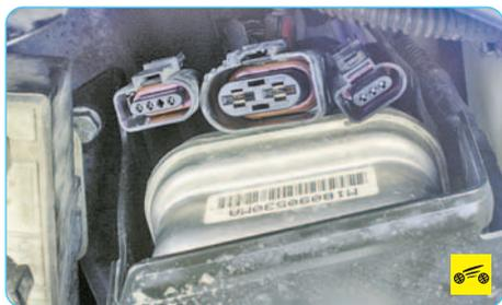
2. Отсоедините колодки жгутов проводов от электрогидравлического блока.
