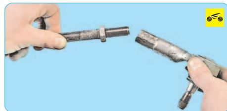
8. ...отверните наконечник от рулевой тяги, подсчитывая количество оборотов, чтобы при установке нового наконечника по возможности не изменилось схождение колес.
