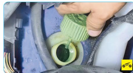
1. Отверните пробку и залейте рабочую жидкость в систему электрогидроусилителя до максимальной отметки (см. «Проверка уровня и доливка рабочей жидкости в бачок электрогидроусилителя рулевого управления», с. 58).
