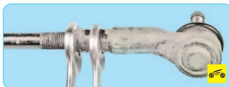
3. Ослабьте затяжку контргайки наконечника рулевой тяги, удерживая наконечник от проворачивания. Для наглядности показано на снятой рулевой тяге.
