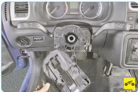
8. Снимите нижнюю часть кожуха рулевой колонки.
