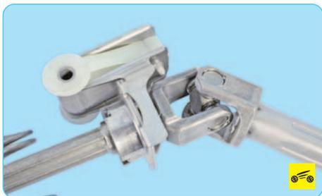
– люфт в карданном шарнире промежуточного вала или повреждение его клеммового соединения с валом рулевой колонки;
