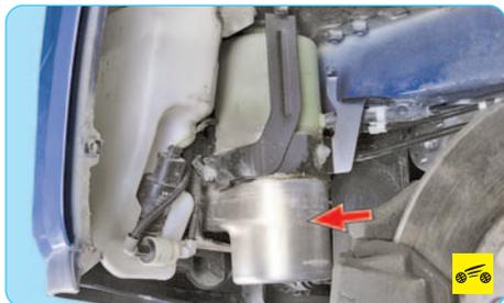
**Гидронасос электрогидравлического усилителя** приводится электродвигателем, благодаря чему его производительность не зависит от оборотов двигателя автомобиля.
