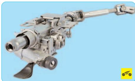
16. Установите рулевую колонку и все снятые детали в порядке, обратном снятию.
