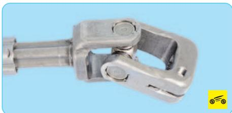
– деформация или повреждение промежуточного вала, люфт в карданных шарни-
