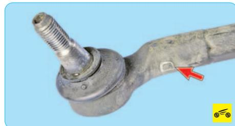
При установке нового наконечника обратите внимание на маркировку, нанесенную на стержень наконечника («D» – наконечник левой рулевой тяги, «С» – наконечник правой рулевой тяги).
