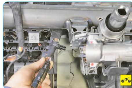
10. ...и отсоедините жгут проводов от рулевой колонки.
