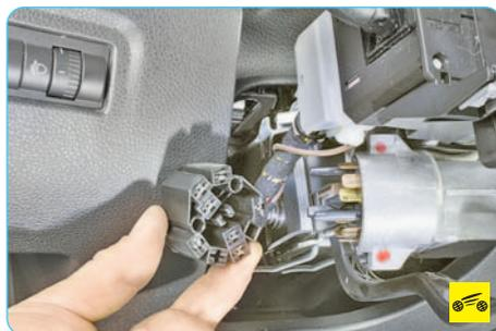
4. Отсоедините колодку жгута проводов контактной группы выключателя зажигания.
