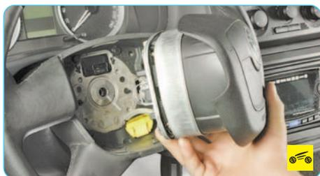
3. Снимите модуль подушки безопасности водителя (см. «Снятие и установка подушки безопасности водителя», с. 272).
